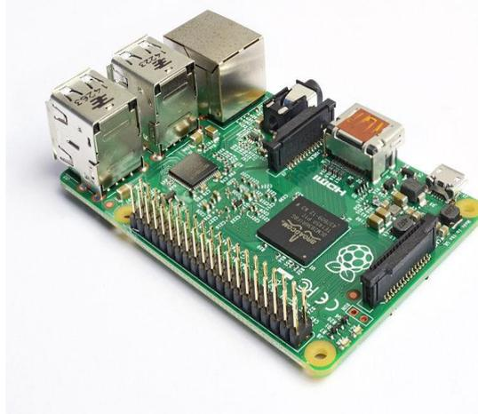
Gambar 2. Raspberry Pi tipe B+
